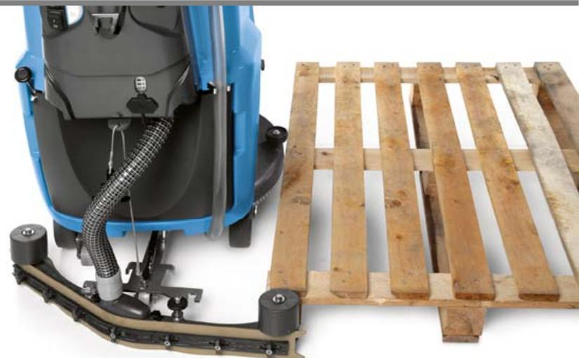
При ударе скребок автоматически отсоединяется
